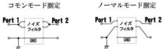
図3. 両モードの測定回路構成
