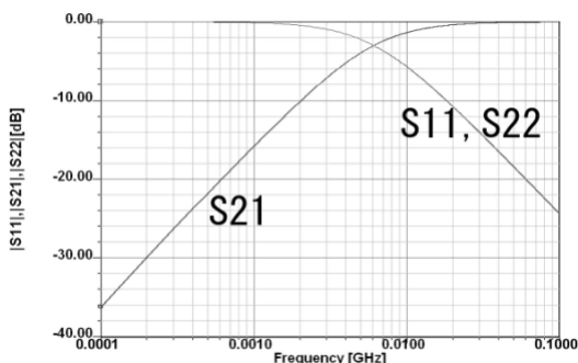
図2 低域側(100MHz以下) S21, S11, S22 Logスケールのシミュレーション結果
